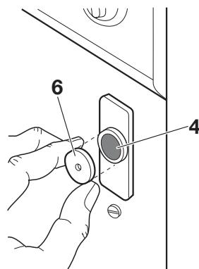
Если вы хотите перевесить дверцу, чтобы она открывалась слева направо, перенесите на другую сторону планки (7), магнит (4) и пластину (5) (Рис. В и Е) Установите ответную часть магнита (6) и петли (1), как описано выше.
