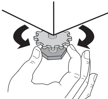
Тщательное выравнивание предотвращает вибрацию, шум и перемещение машины во время работы.
