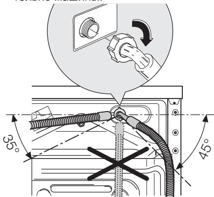
3. Отрегулируйте положение шланга, ослабив зажимную гайку. Отрегулировав положение шланга, не забудьте плотно затянуть зажимную гайку для предотвращения утечек.
