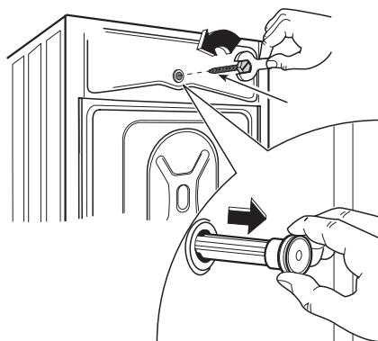
4. Отвинтите и снимите два больших задних болта **B** и шесть маленьких болтов **C**.
