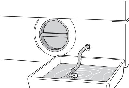
5. Когда вода перестанет литься, отвинтите крышку фильтра (A) и извлеките его. Всегда держите под рукой тряпку, чтобы вытереть воду, которая может пролиться при снятии фильтра.
